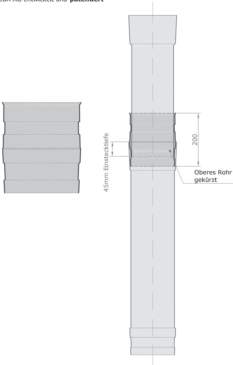
Der Adapter konisch-zylindrisch wird dort eingesetzt, wo konische Rohre gekürzt werden müssen und eine einfache, stabile, platzsparende, überdruckdichte Verbindung gefordert wird.
