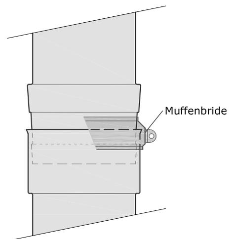
Muffenbride ohne Dichtung -> Unterdruck
