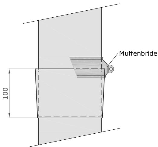
Muffenbride ohne Dichtung -> Unterdruck
